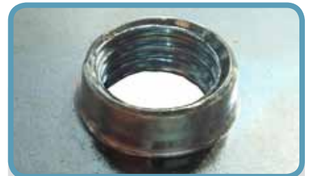
Gewinde M10 x 1,50 • S420MC - Dicke: 3 mm • Gewindehöhe: 6,5 mm Anzugsmoment: 75 N.m
